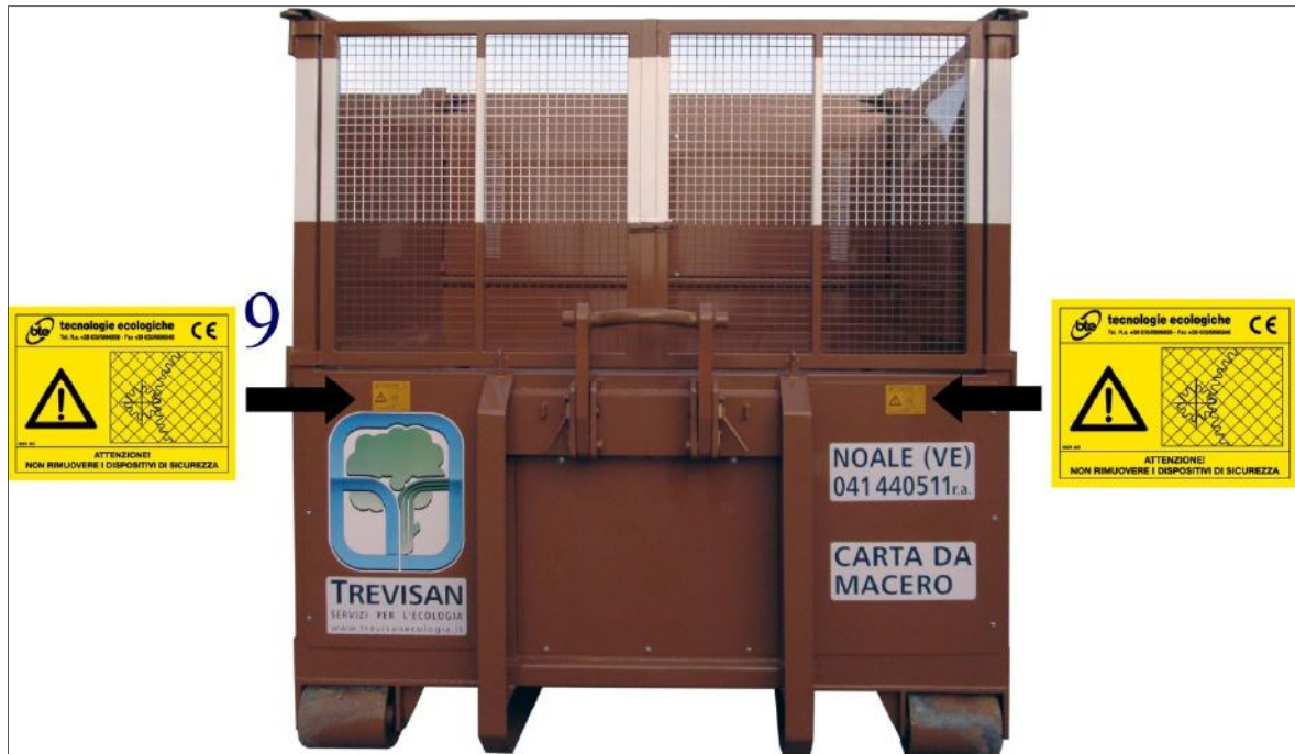
Figura 3 -Targhette e adesivi di sicurezza sul frontale.
